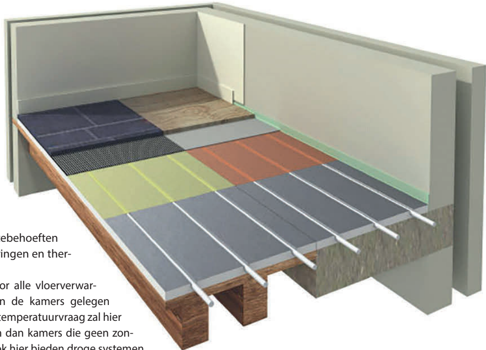
Vloeropbouw bij droogstelsel, illustratie van Vasco
